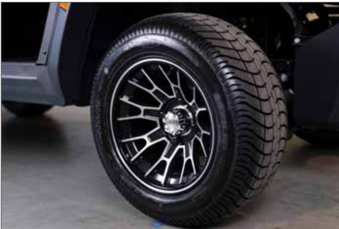
Bereifung: 20x9-12 mit 12-Zoll-Aluminiumfelgen
