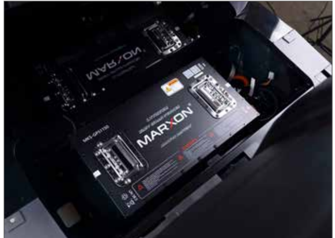
Abschließbares, geschütztes Batteriefach unter der Sitzbank
