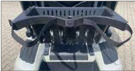
Werkzeuglos montierbarer Golfbag-Halter
