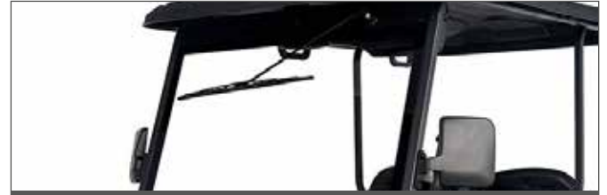
Frontscheibe aus Sicherheitsglas mit Scheibenwischer*
