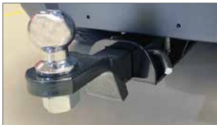
Anhängekupplung Kugelkopf aus Stahl
